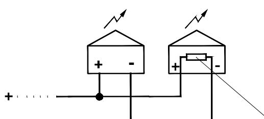
Resistenze per monitoraggio cavi (1KOhm) sul collegamento della tensione d'esercizio.
