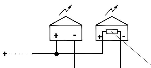
Элемент сопротивления для контроля цепи (1 кОм) на соединении рабочего напряжения.
