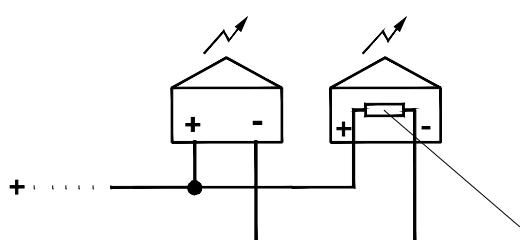
Résistance pour surveillance de ligne (1KOhm) au niveau du raccordement à la tension de service.
