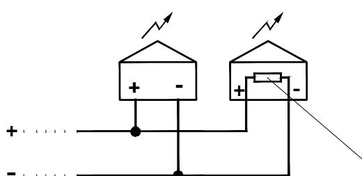
Widerstand für Leitungsüberwachung (1K Ohm) am Betriebsspannungsanschluss.
